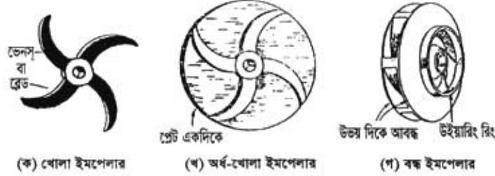
চিত্র- ১৬.৬: বিভিন্ন প্রকার ইমপেলার।
