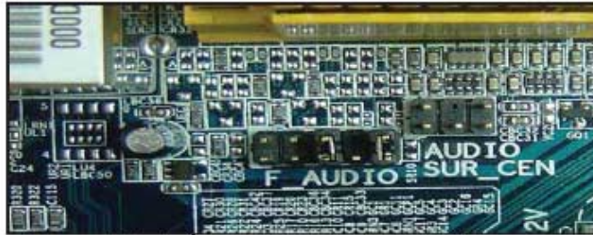
চিত্র-৩ : মাদারবোর্ডের এই স্থানে কেস গুয়্যারগুলো ইন্টল করতে হবে
