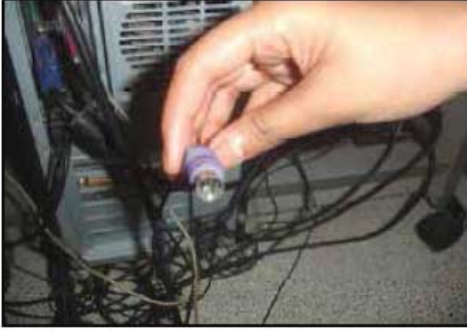
চিত্র : বেঙ্গনী রঙের কী-বোর্ড মেইল কানেক্টর যা কী-বোর্ডের কিমেল পোর্টে লাগানো থাকে
