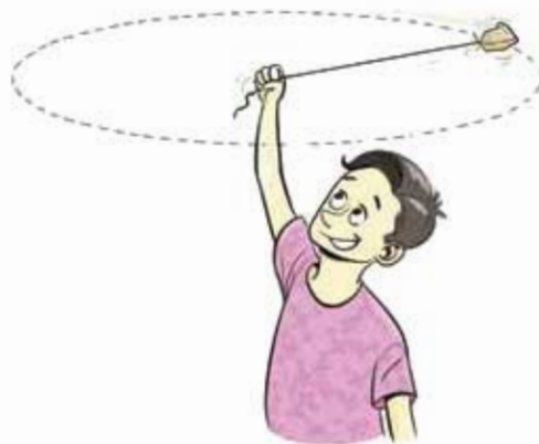
চিত্র 2.05: সুতা বেঁধে একটি পাথর ঘোরানো হলে দ্রুতি এক থাকলেও বেগের পরিবর্তন হয়।
