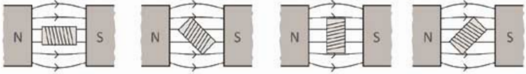
চিত্র 12.10: বৈদ্যুতিক মোটর একটি তড়িতচুম্বকের ভেতর দিয়ে এমনভাবে বিদ্যুৎ প্রবাহ করানো হয়, যেন সব সময়েই এটি ঘুরতে থাকে।
