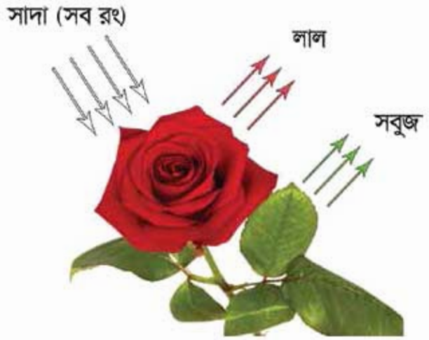
চিত্র 8.06: একটা বস্তু সব রং শোষণ করে যেটা প্রতিফলিত করে সেটাকেই তার রং বলে মনে হয়।
