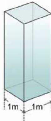
চিত্র 5.06: বাতাসের চাপটি আসে বাতাসের স্তম্ভের ওজন থেকে।
