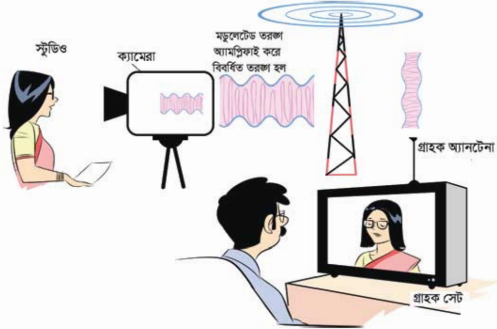
চিত্র 13.14: টেলিভিশন সম্প্রচার প্রক্রিয়া
