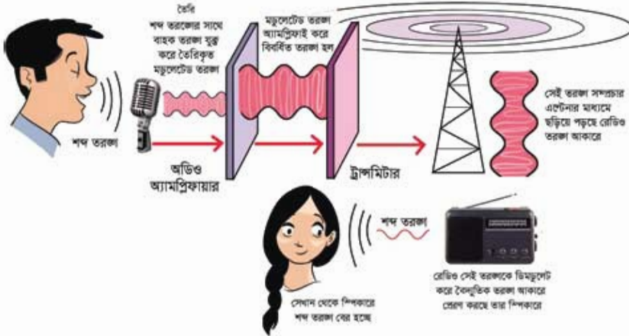
চিত্র 13.12: রেডিও সম্প্রচার প্রক্রিয়া।
