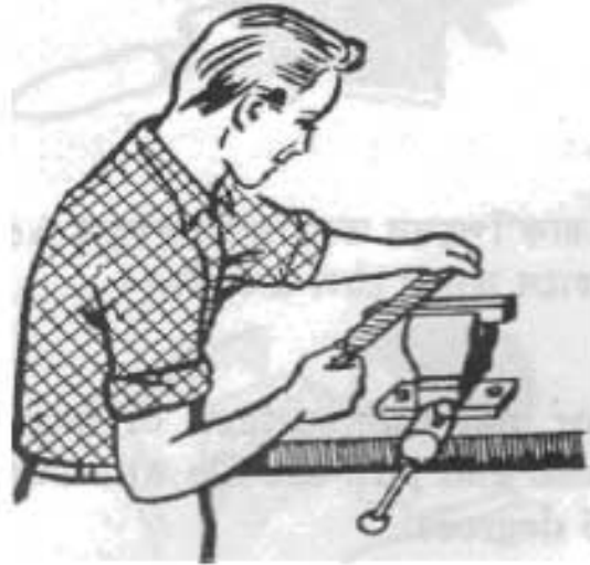
চিত্র-৩.১১ঃ ঝাঁক ফাইলিং এ ফাইল চালানোর কৌশল।
