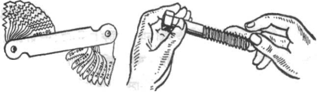
চিত্র-৮.১০- প্যাচ কাটার সময় এবং পরে পরীক্ষা করণ
