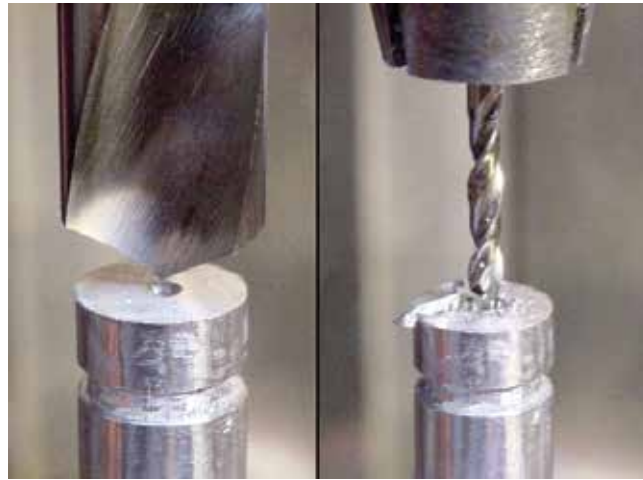
চিত্র-২০.৭ঃ সেন্টার ড্রিলিং প্রক্রিয়া
