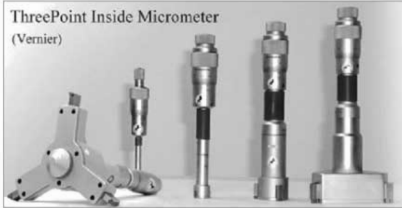
চিত্র-৭.৫ঃ থ্রি পয়েন্ট রড টাইপ ইনসাইড মাইক্রোমিটার
