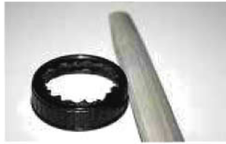
চিত্র-১৫.১৭ঃ হাফ রাউন্ড ফাইলের ব্যবহার
