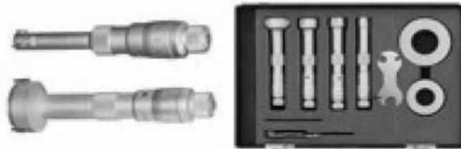
চিত্র-১১.১১: রড টাইপ ইনসাইড মাইক্রোমিটার
