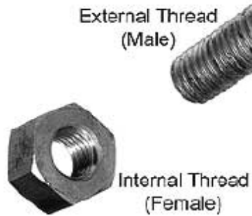
চিত্র-২২.২ : ট্যাপিং এর মাধ্যমে তৈরি করা নাটের ইস্টারনাল থ্রেড
