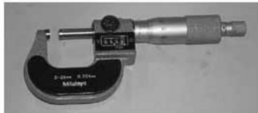
চিত্র-১১.৪: প্লেইন আউটসাইড মাইক্রোমিটার
