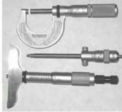
চিত্র-১১.৩: আউট সাইড, ইনসাইড ও ডেপথ মাইক্রোমিটার।
