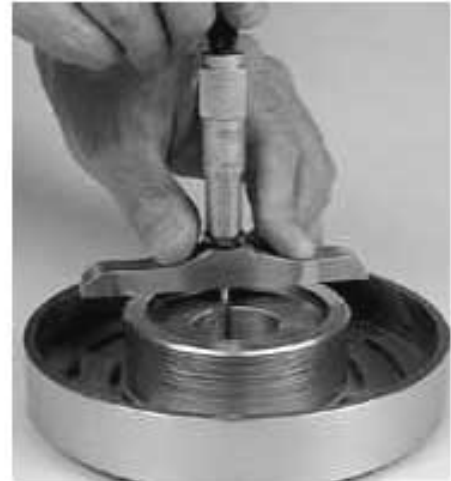
চিত্র-৬.২। ত্রেপথ মাইক্রোমিটার ওয়াকপিসলের মধ্যে স্থাপন কৌশল
