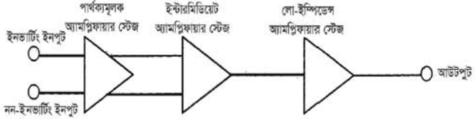
চিত্র : OP-Amp এর অভ্যন্তরীণ গঠন
