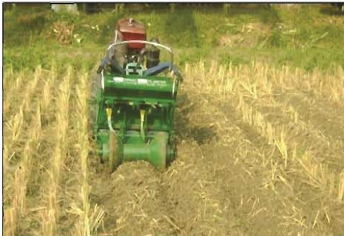
পাওয়ার টিলার চালিত বেড প্রস্টার যন্ত্রের সাহায্যে গম বপন
