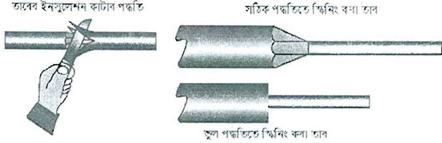
চিত্র ১১.১: পরিবাহী তারের ইনসুলেশন কাটা বা স্কিনিং করা।
